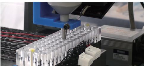
上記は約 60 線へのワイヤハーネスに対して気中放電にて試験を実施する際の例です。この場合、6000 回の放電試験を全て自動にて実施する事ができるようになります。
