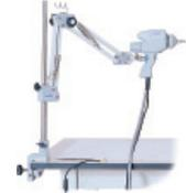
本製品は、ISO 10605 Ed.2 をはじめとする静電気試験環境の改善を目的に従来の自立型スタンドを改良し、放電ガンの据付・脱着を容易に、しかも放電ガンを供試体の試験位置へ任意に移動・設定できるように開発したものです。本製品を使用することにより放電ガンを上下・左右の任意の位置に移動して試験がおこなえます。(ISO 規格対象外品)
