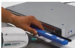
静電気試験を実施する際に、供試体 (EUT / DUT) が蓄積している電荷を除去するためのブラシです。
