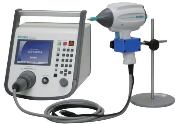
※ 半導体向け100pF-1.5kΩ（人体モデル：HBM）および200pF-0Ω（マシンモデル：MM）の静電気試験を行なう場合は、半導体用静電気試験器 Model:ESS-6002/6008をご提供しております。
