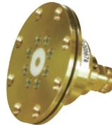
ISO 10605 Ed.2 規格に要求される抵抗負荷（電流検出用）です。静電気放電の電流波形を測定する際に使用します。また、本ターゲットを校正するためのアダプタ（06-00068A）もご用意しております。
