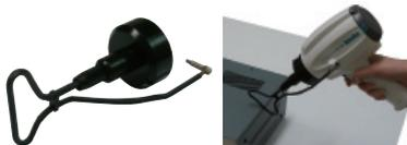
衝撃磁界アダプタは、ノイズの誘導モードである、電磁誘導をシミュレーションするためのアダプタであり、静電気試験器と放電ガンを組み合わせて使用します。
