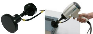
衝撃電界アダプタは、ノイズの誘導モードである、静電誘導をシミュレーションするためのアダプタであり、静電気試験器と放電ガンを組み合わせて使用します。
