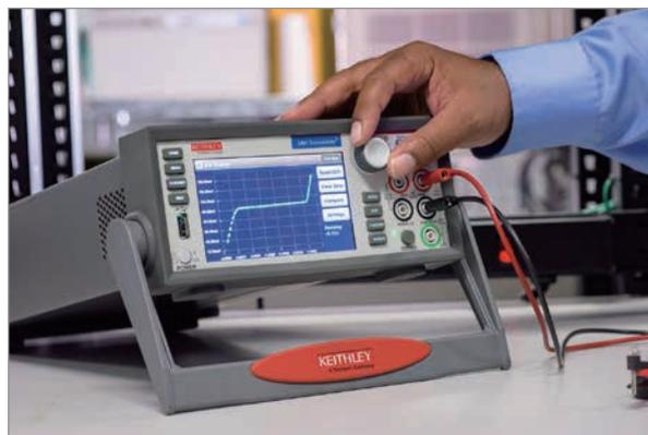
フロントパネルのノブを使用して、リアルタイムでカーブ調整とデータ確認
