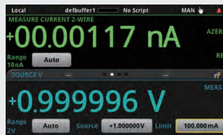
• 6.5桁の高精度測定、0.01pA分解能微小電流測定
