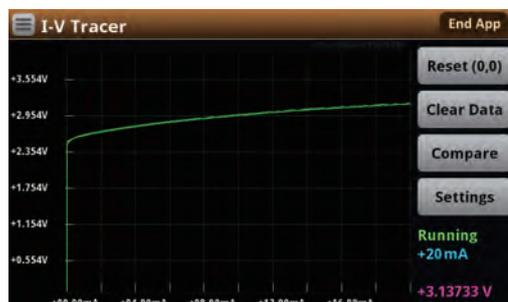
電流印加モードにより、電流対電圧もプロット可能
