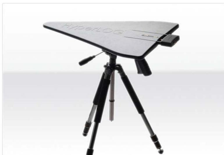
優れた指向性と高出力電力を備えたポータブルRF電界強度信号発生器DFG4060。EMC測定またはシールド効果の評価に最適なテストツールです。シールドルームや電波暗室などの性能評価を簡単に行えます。また、通信設備やアンテナなどフィールドでの保守点検にも有効です。
