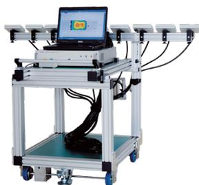
DSRCアンテナME9301から発射される電波の強さ(電界強度)を測定する機器です。
