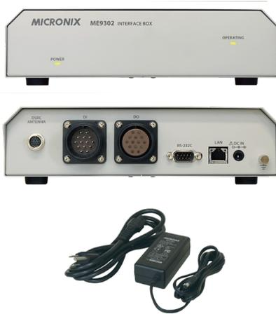
DSRCアンテナME9301からWCNを受け取り、WCNとDIを基に本器内のMPUで処理を行ってDOに出力します。
