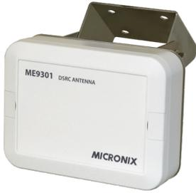
車両に搭載されたETC車載器と通信を行い、WCNを読み取るための機器です。読み取ったWCNは、シリアル通信のRS-422Aを介してインタフェースボックスME9302へ伝送されます。また、電源はME9302から供給されます。
