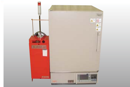
恒温槽同期制御・消火器設備
