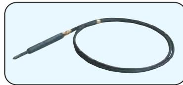
CP-2Sの磁界検出部は高周波特性に優れたガラスセラミック多層基板技術を採用したシールドループ構造ですから、磁界成分だけを検出し、再現性の良い測定が行えます。測定周波数は10MHz～3GHzと広く、測定値はMSA338E内で校正されます。
