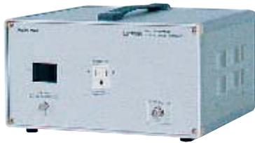
電源ラインを通して放出される伝導性妨害ノイズを測定する際、その測定値は電源ラインのインピーダンスに影響を受けます。インピーダンスが低ければノイズ量は少なく測定され、反対にインピーダンスが高ければノイズ量は多く測定されてしまいます。これでは、測定値に普遍性や信頼性はありません。そこで、安定的にかつ再現性のある妨害ノイズ測定を行うために、電源ラインのインピーダンスを一定化する必要があります。ラインインピーダンス安定化回路網 (Line Impedance Stabilization Network) を電源ラインに挿入することによって、EUTからみた電源ラインのインピーダンスを一定にします。ただし、電源ラインインピーダンスは周波数特性をもっていますが、その特性カーブはCISPR等により規定されています。
