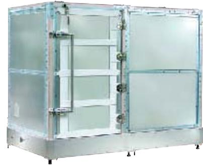
MY5410は、直径756mm、耐荷重100kgのターンテーブルを備えており、大型EUT用の電波暗箱です。広帯域アンテナはMAN102が設置されています。また、アンテナ支持マストが装備されており、アンテナを手動で上下に10cm間隔で最大90cm移動させることができます。電波吸収材はMY5310と同じものを使用しています。
