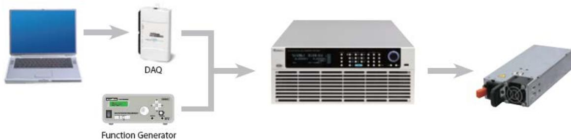
実際の電流プロファイルと波形をシミュレーションするため、ユーザー定義波形（UDW）に対応した拡張機能を有しています。実際の電流波形を再構築するために、ユーザーはソフトパネル（オプション）を介して、取得した波形データをアップロードすることが可能です。より厳しい試験要求に対応するため、最大150万のデータポイントからなる10セットまでの波形を保存することが可能です。
