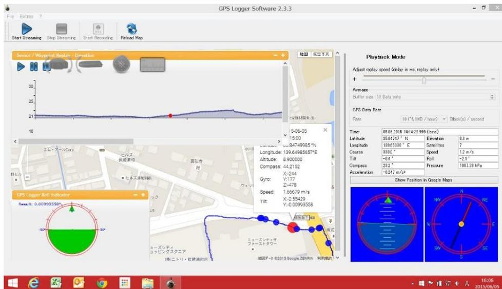
このGPSロガーは最大35ログの高速更新レートを提供します。最大レートでは、50MB/時(圧縮なし)をも生成し、容量2GBのmicroSDで、フルスピードで最大約2日分を記録します。データレートは保存するデータの量により、より低いレートに調整することもでき、microSDカード上への記録を1週間または数か月といった長い時間に調整することも出来ます。GPSロガーは内蔵のLiPoバッテリー(スタンドアローン)で使用可能ですが、USBで操作時間に制限なく使用することも出来ます。
