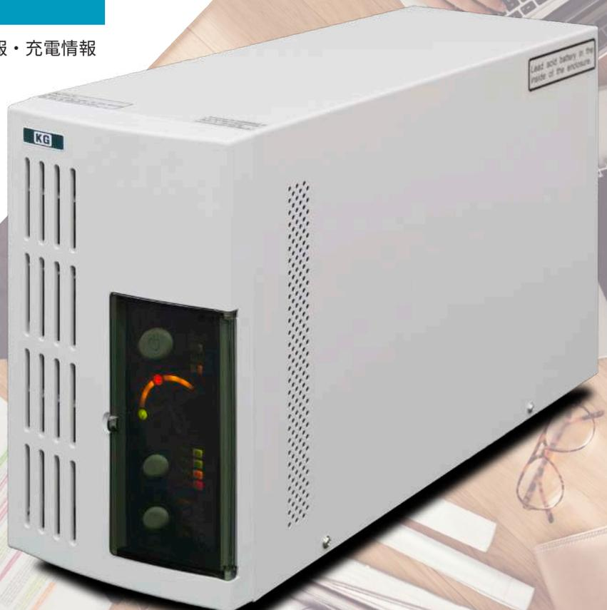
UTシリーズは高効率コンバータを搭載した主パソコン、サーバー、コンピュータールームなどのOA機器電源バックアップ用に最適なタワー(据置)型の常時インバータ給電方式無停電電源装置です。出力容量は1.5kVA～3kVAの小型容量をラインナップ。環境や用途に応じてフロントパネルより出力電圧の変更が可能です(S1タイプ:100/110/115/120V、S2タイプ:200/220/230/240V)。また負荷率0.7、クレストファクタ≦3まで供給可能で広範囲の用途でお使いいただけます。
