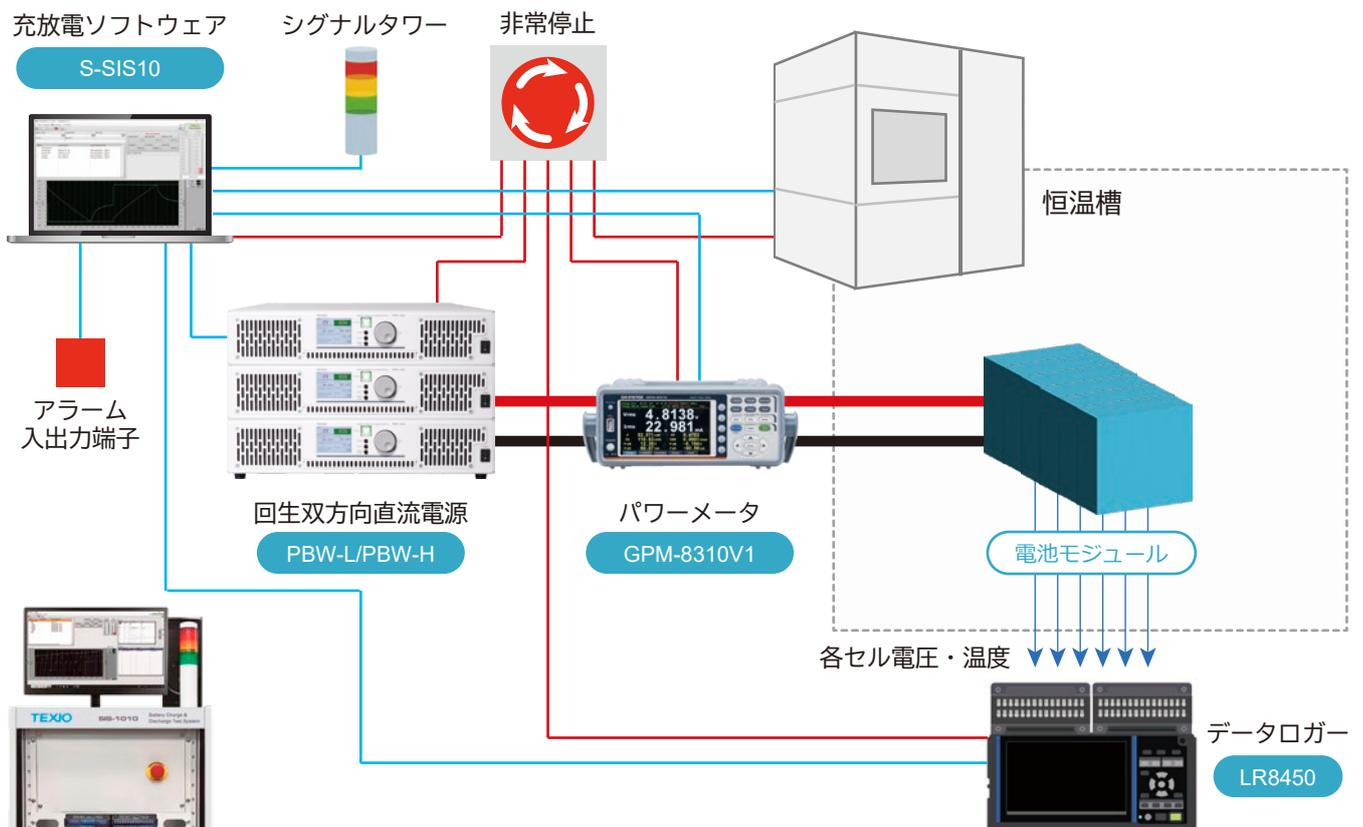
恒温槽・各セル電圧・温度監視もサポートするバッテリー充放電システム
