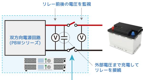
バッテリーの逆接続があっても接続されない仕組みで安全
