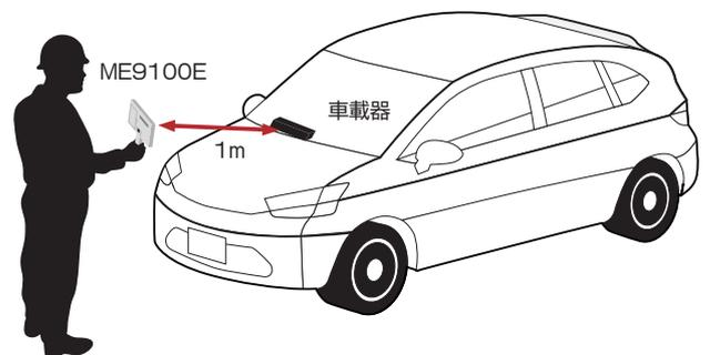
また、図に示すようにME9100Eと車載器を平行に対向させ、1m(0.8～1.2mの範囲)離して試験を行います。この状態で通信試験をすると、車載器の電波の強さも同時にチェックすることができます。パスであれば車載器の電波の強さは正常です。0.8m以内でないパスにならない場合は、車載器の電波が弱いのでケーブル配線や車載器を再チェックします。
