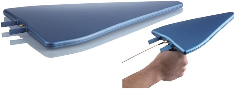
広帯域かつ軽量・安価なログペリアンテナです。当社製ハンディ型スペクトラムアナライザとの組み合わせに適しています。また、当社製スペアナ内でアンテナゲイン補正を行うことで、電界強度 (dB  $\mu$ V/m)換算した値が直読できます。
