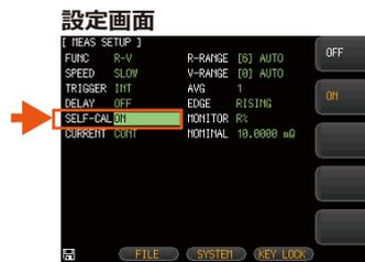
自己校正機能は、内部回路のオフセット電圧とゲインドリフトを除去し、測定精度を向上させます。測定速度 Slow では常に自己校正を実行します。Medium 以上の測定速度では、自己校正機能が ON の場合、自動的に30分毎に校正を実行します。外部トリガの場合自己校正は自動で実行されません。ハンドラの校正実行端子の制御で実行が可能です。
