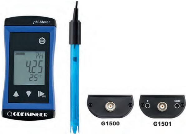
G1500/1501は手のひらサイズの小型防水pH計です。大型のディスプレイを採用し、視認性に優れ、電池寿命も3000時間以上の長寿命です。G1501はpH電極以外に温度センサの入力があり、pH、温度、Redoxの測定ができます。接続はBNCコネクタで、用途に合わせて電極を交換できます。
