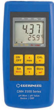
GMH3500シリーズはRedox、温度測定が可能なpH計です。Pt1000温度プローブで自動温度補正を行うことができます。3機種ともにPC接続機能、0~1Vアナログ出力を備え、外部電源も使用できるため、長期連続測定も可能です。pH電極は用途に合わせて11種類ラインアップしています。
