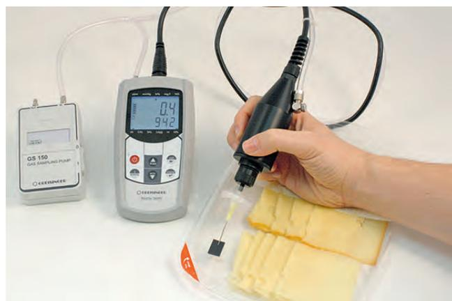
ResOx5695-H/Lはパッケージ内の残存酸素の測定、確認を行うための酸素濃度測定セットです。不活性ガスの充填されている食品パッケージなどに酸素が残っているかを確認したり、高濃度酸素を充填している場合の内部酸素を測定することができます。測定器とポンプはともに電池駆動で、検査する場所を問わず測定することができます。
