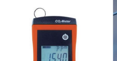
このCO<sub>2</sub>アラーム計は、超コンパクトなデザインと、超高性能なCO<sub>2</sub>センサーを搭載し、高精度でCO<sub>2</sub>濃度を測定します。アラーム音が鳴ると、ディスプレイにアラーム状態が表示されます。設定しきい値を超えるとブザー音(2段階)と、ディスプレイ上のシンボル表示でアラーム状態を知らせます。内蔵のリチャージャブルNiMH電池のフル充電で約24時間動作し、USB給電により約8時間で充電を完了します。約400ppmの新鮮空気(または校正ガス)で基準校正も簡単に行うことができ、長期にわたって精度が維持できます。本体に備わっているクリップでベルトに装着、またはストラップでのぶら下げもできます。測定開口部(スリット)は本体上面に設けられています。
