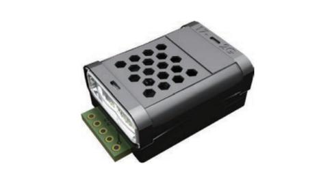
センセエアSunriseは新世代NDIRセンサです。リッドステート光学系と最新のエレクトロニクスにより、丈夫で振動に対しても高い耐性を備えたセンサが実現しました。このリッドステートデザインは、過酷な環境や爆発リスクのあるアプリケーションにおいても優位性を発揮します。NDIRセンサとして初めてLEDテクノロジーを導入したSunriseは、高い測定精度を維持しつつ、真に省電力のセンサです。Sunriseは±30ppm±3%rdgの精度(CO<sub>2</sub>)を持ちながら、電力消費は市場の低消費電力NDIRセンサの約1/5の低さです。平均消費電流は僅かに<45μAです。内蔵のABCアルゴリズム(自動ベースライン補正機能)により、取付け後はメンテナンスフリーで、期待寿命15年の後も精度を維持します。無線のアプリケーションでは特に、メンテナンスフリー、超低消費電力で駆動できるセンサがより重要になります。
