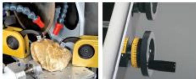
GEOCUT 302は、鉱物、岩石、コンクリート、ガラス、セラミックス、耐火物およびその他の地質サンプルを切断するために設計されたX-Y-テーブル付きの頑丈な手動カッターです。
