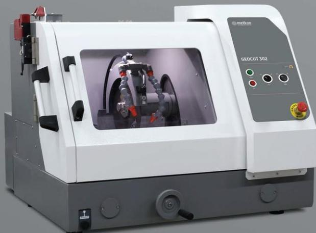
GEOCUT 302は、岩石、セラミックス、鉱物、ガラス、コンクリート、地質標本の切断に最適な高度な岩石切断機です。
