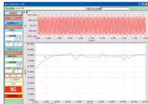
エンドレススループット収録判定は、音響振動の波形データから常時異常判定を行い、異常が発生した際の時間波形データを収録/保存します。通常のスループットは、異常判定が発生するまでに時間がかかるのと、保存容量が大きくなりますが、エンドレススループットは異常判定が発生した時より前の不要なデータを自動削除するので保存容量に余裕ができ、長時間の測定が可能になります。
