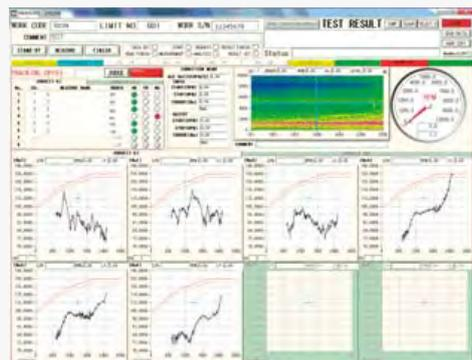
測定対象物が定常回転の時にFFT判定を行い、横軸：周波数、縦軸：レベルで閾値判定をします。回転が上昇・下降する測定対象物の時にはオーダートラッキング判定を行い、回転数を同時に計測し次数を計算して、設定した次数毎に横軸：回転、縦軸：レベルで閾値判定をします。測定対象物の種類毎に判定閾値を設定することが可能です。
