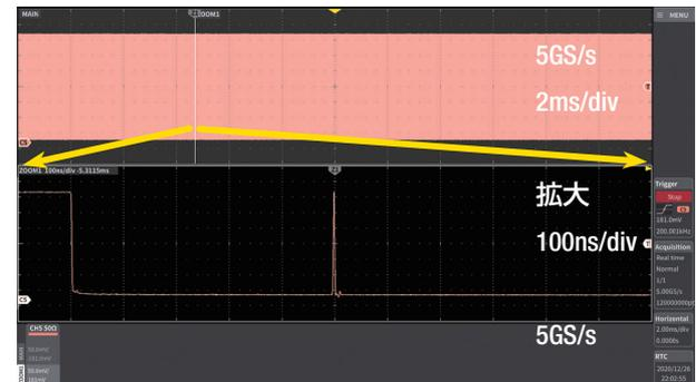
メモリ長最大120Mポイント (チャンネル結合時) 60Mポイント (全チャンネル使用時)
