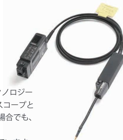
IsoVu技術はコモンモード・ノイズに埋もれていた信号を可視化する革新のテクノロジーです。E/Oセンサを利用して電気信号を光信号に変換することにより、オシロスコープと被測定デバイスを電氣的に完全に絶縁します。大きなコモンモード電圧がある場合でも、高い周波数の差動信号を正確に測定できる唯一の測定システムです。
